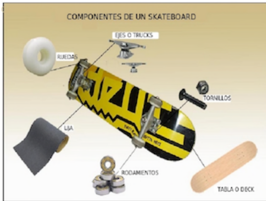
Foto 2.1 Componentes de un skateboard
